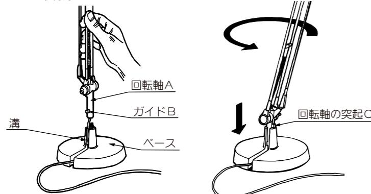
上図のように器具の軸を支え、回転軸AをガイドBが、ベースの溝に沿うような向きで、ベースに差し込みます。
