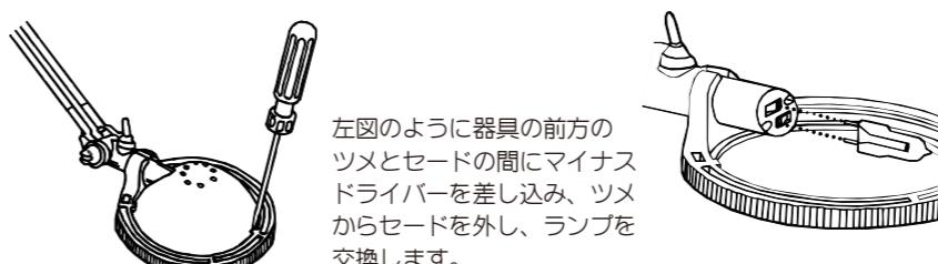
左図のように器具の前方のツメとセードの間にマイナスドライバーを差し込み、ツメからセードを外し、ランプを交換します。
