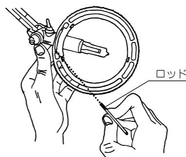
灯具がテーブル面に直接触れないように、左図の位置(どちらか一方)に必ず、ロッドをねじ込んでください。
