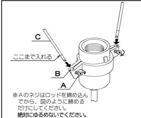
お買い求めの状態、ネジ(A)は少し緩めてあります。ロッド固定部(B)にセード支持ロッド(C)を上図のように線まで差し込んでから、ネジを締め直し、固定してください。絶対にネジを外さないでください。またロッド固定部は分解しないでください。部品の取付に不備があると、セード落下の原因になります。
