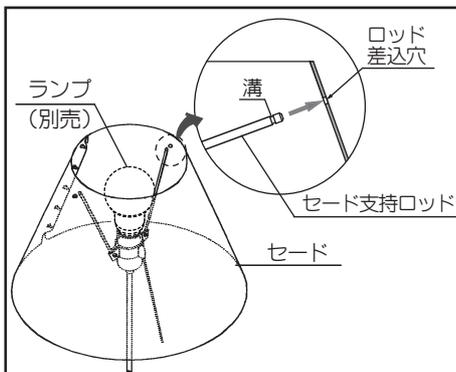
セードにあいた、ロッド差込穴にセード支持ロッドを差し込み、溝の部分で止めます。不備があるとセード落下の原因となります。(別紙セード側取扱説明書参照)
