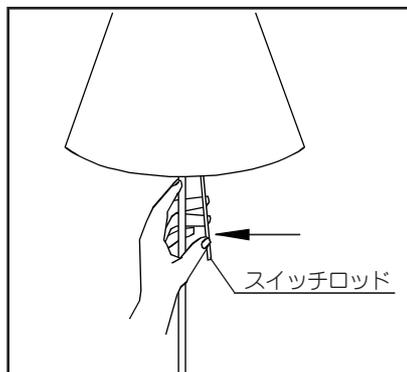
上図のようにスイッチロッドを静かに支柱の方に押しすと、ON-OFFの切替えができます。(長期に渡ってご使用にならない時は、コンセントから電源プラグを抜いてください)
