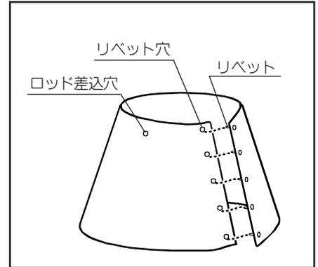
リベットを各々対応するリベット穴にカチツと音がするまで押し込んでください。リベットは一度押し込むと抜けませんので、順番に注意してください。(別紙セード側取扱説明書参照)
