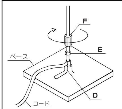
コードをベースの切り欠き部(D)に合わせ、保護ブッシュ(E)を差し込みます。器具を保護ブッシュの上に乘せて、固定ナット(F)で支柱を固定します。保護ブッシュの差し込みや締付けに不備があると、感電・転倒・火災等の原因となります。
