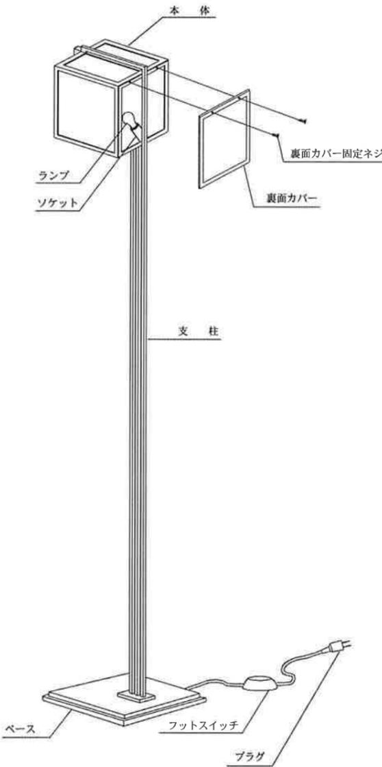
1. 本体裏面カバー固定ネジをゆるめ裏面カバーを本体より外してください。
