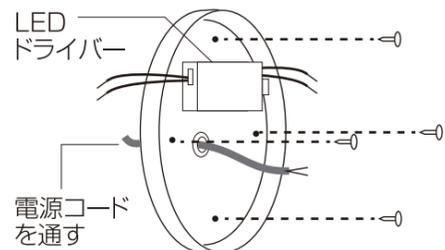
②電源接続棒端子を電源へ接続します。
