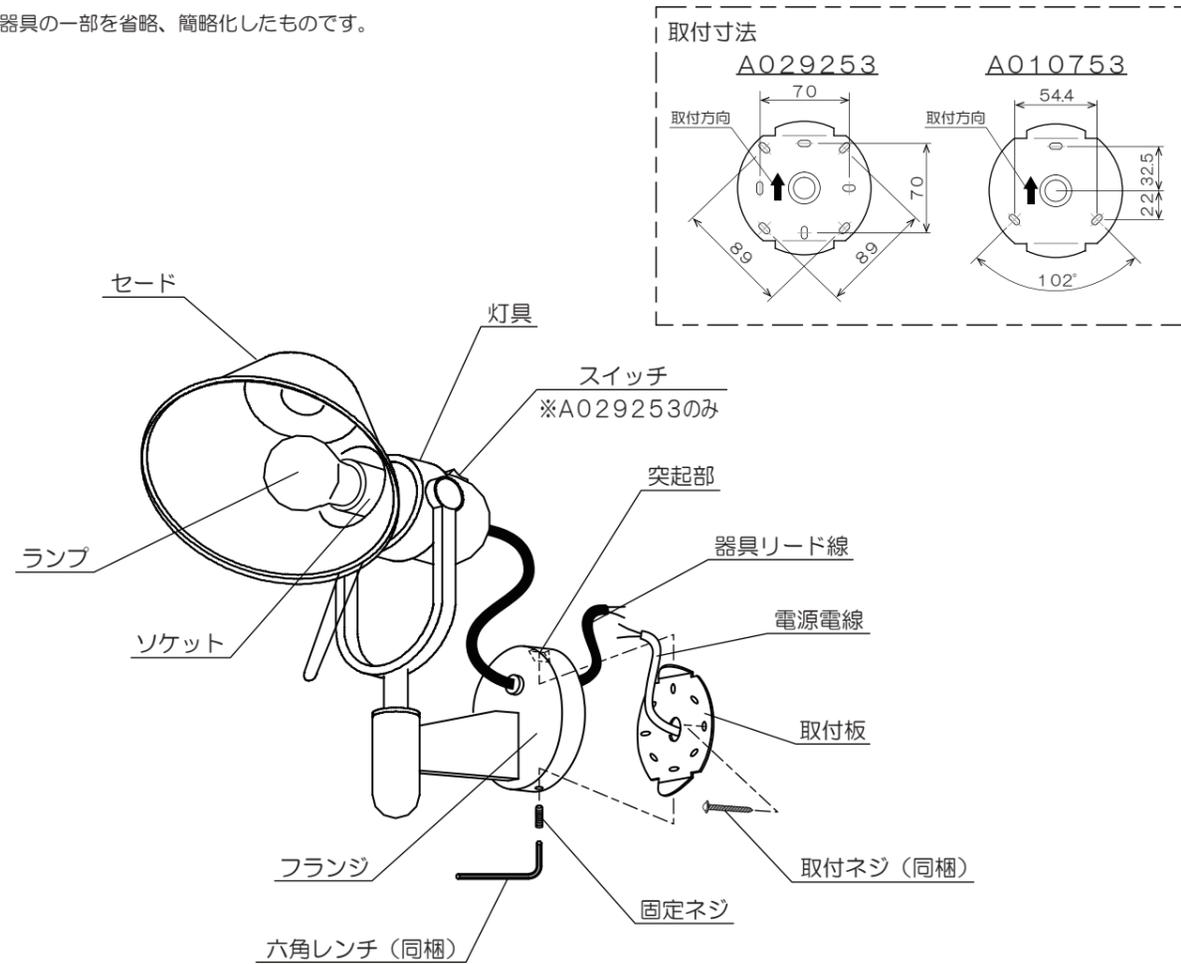
1. 取付板を壁面に付属の取付ネジで取り付けてください。
