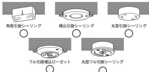
●上図以外の引掛シーリングボディが付いている場合は、角型引掛シーリングボディにお取り替える工事を専門の電気工事店へご依頼してください。
