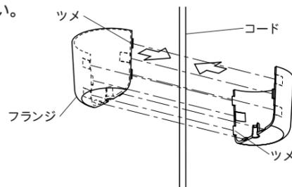
●コードハンガーをご使用の場合は、①図の様に天井の補強材ある位置に取り付けて、器具の高さを調節してください。
