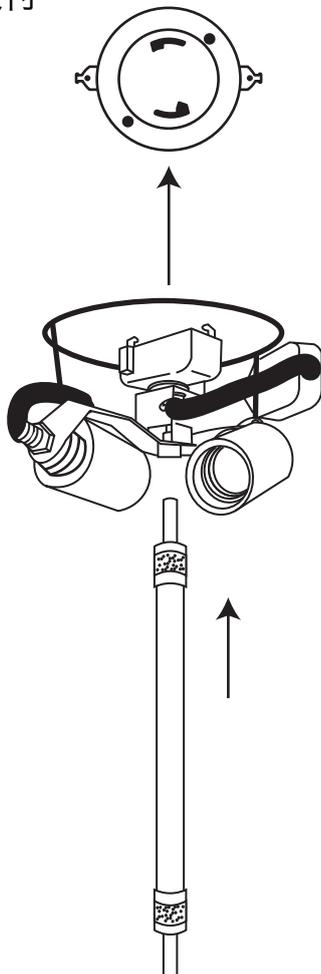
①引掛けプラグを引掛けシーリング又は埋込ローゼットに取り付けます。
