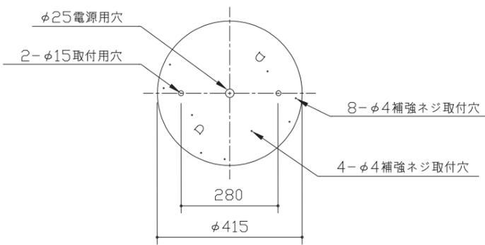
取付板外形寸法及びボルト出し寸法(単位mm)
