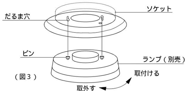
ランプはソケットに確実に取付けてください。落下によるけがの原因となります。
