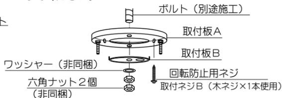
※器具は、組みあげて梱包されていますので取付方法と逆に1度、分解してから器具の取付をしてください。
