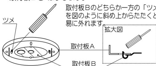
取付板Bのどちらか一方の「ツメ」を図のように斜め上からたたくと容易に外れます。
