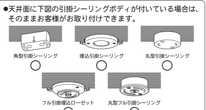
●上図のシーリングボディが付いていない場合は専門の電気工事店へご依頼ください。シーリングボディの取付の際は十分な長さの取付ネジ2本で天井の補強材のある位置に取り付けてください。
