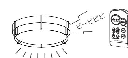
③ リモコンの右側についているチャンネル切り替えスイッチから本体に合わせたチャンネルに変更する。
