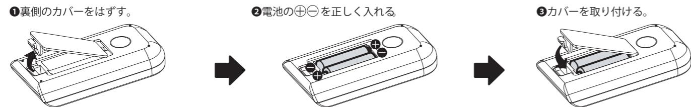
使用する電池や条件により半年未満で消耗することがあります。※付属の電池は動作確認用ですので、電池寿命が短くなる場合があります。交換時は、2本とも新しい同じ種類のものを使用してください。長期間使わないときは、電池を取り出してください。(液漏れによる故障防止)
