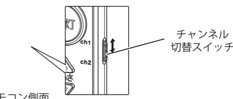
※チャンネルの初期設定は照明器具本体・リモコンともにチャンネル1に設定されています。
