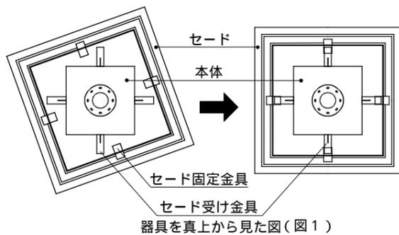
下図のようにセード固定ネジ2本で締め付けてください。
