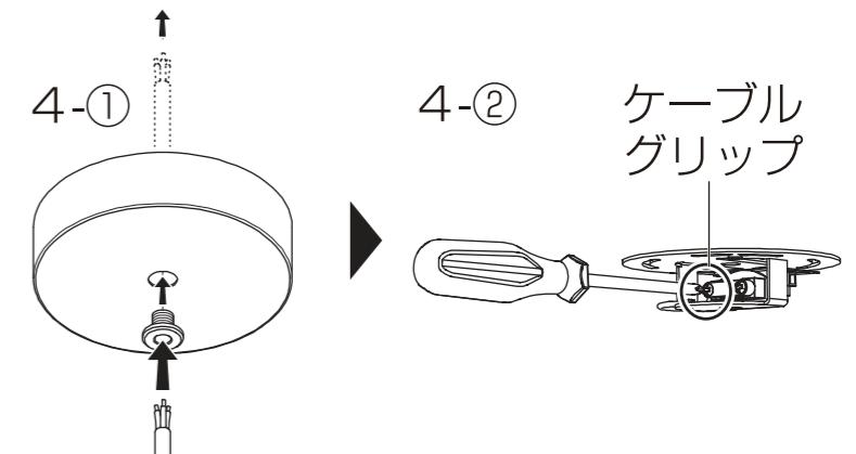
※必ず照明器具側の電源コードを固定してください。
