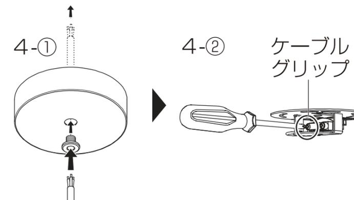
※必ず照明器具側の電源コードを固定してください。
