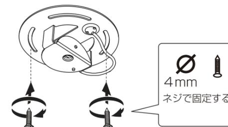
ねじ止めをする取付面の裏側に補強材をあてて、施工してください。
