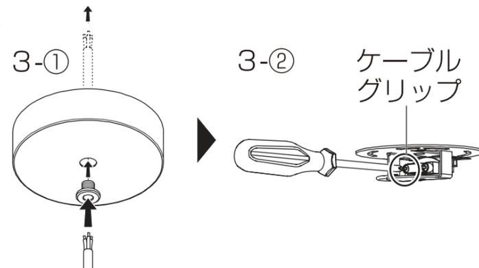
※必ず照明器具側の電源コードを固定してください。
