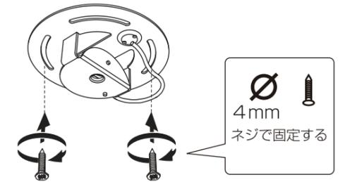
ねじ止めをする取付面の裏側に補強材をあてて、施工してください。
