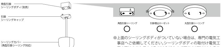
事店へご依頼してください。シーリングボディの取付け電気工 事の際は充分な長さの取付けネジ2本で天井の補強材のある位 置に取付けてください。
