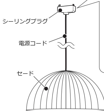
**注意** お取り付け前に天井の配線器具をご確認ください。天井にシーリングコンセントが付いていない場合、電気工事店に取り付けを依頼してください。
