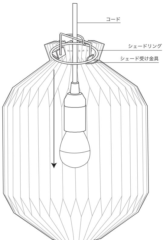
③取り付けた電球（ランプソケット側）をシェード上部から下部へ通します。
