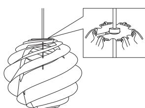
④アクリルプレートの 6 か所の穴に、フレームのフックを確実に引掛けます。
