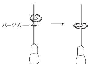
②アクリルプレートの切込み部分にコードを挟みパートAの上に設置します。
