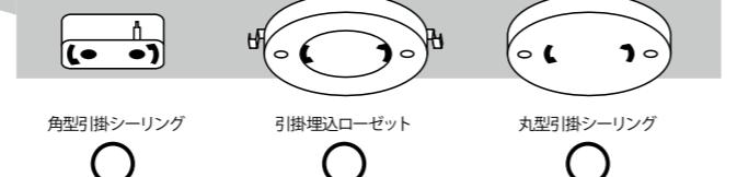
●上面のシーリングボディがついていない場合は、専門の電気工事店へご依頼してください。シーリングボディの取付け電気工事の際は充分な長さの取付けネジ 2 本で天井の補強材のある位置に取付けてください。
