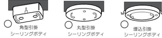
●上図の引掛シーリングボディが付いていない場合は、専門の電気工事店へご依頼ください。引掛シーリングボディ取付電気工事の際は十分な長さの取付ネジ2本で天井の補強材のある位置に取付けてください。
