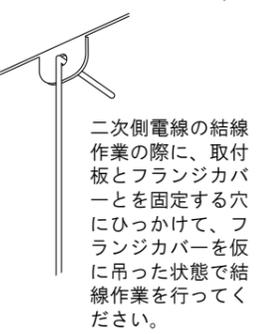
二次側電線の結線作業の際に、取付板とフランジカバーとを固定する穴にひっかけて、フランジカバーを仮に吊った状態で結線作業を行ってください。
