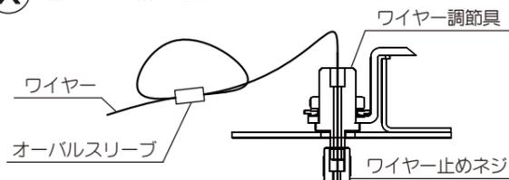
ワイヤー末端は、余分なワイヤーをカットし、先端に輪をつくり、付属のオーバースリーブでかしませてください。
