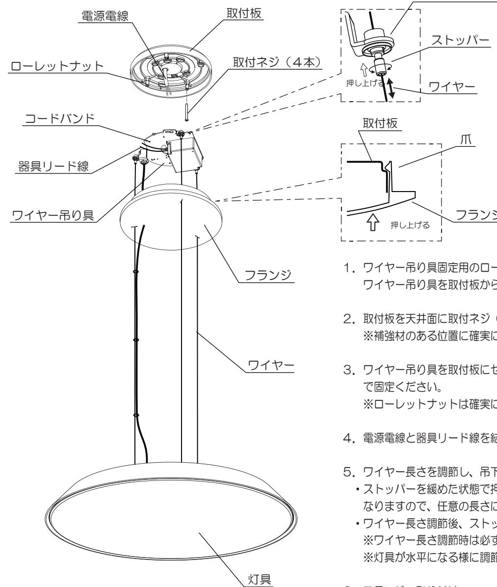
1. ワイヤー吊り具固定用のローレットナット（3箇所）をゆるめてワイヤー吊り具を取り外してください。
