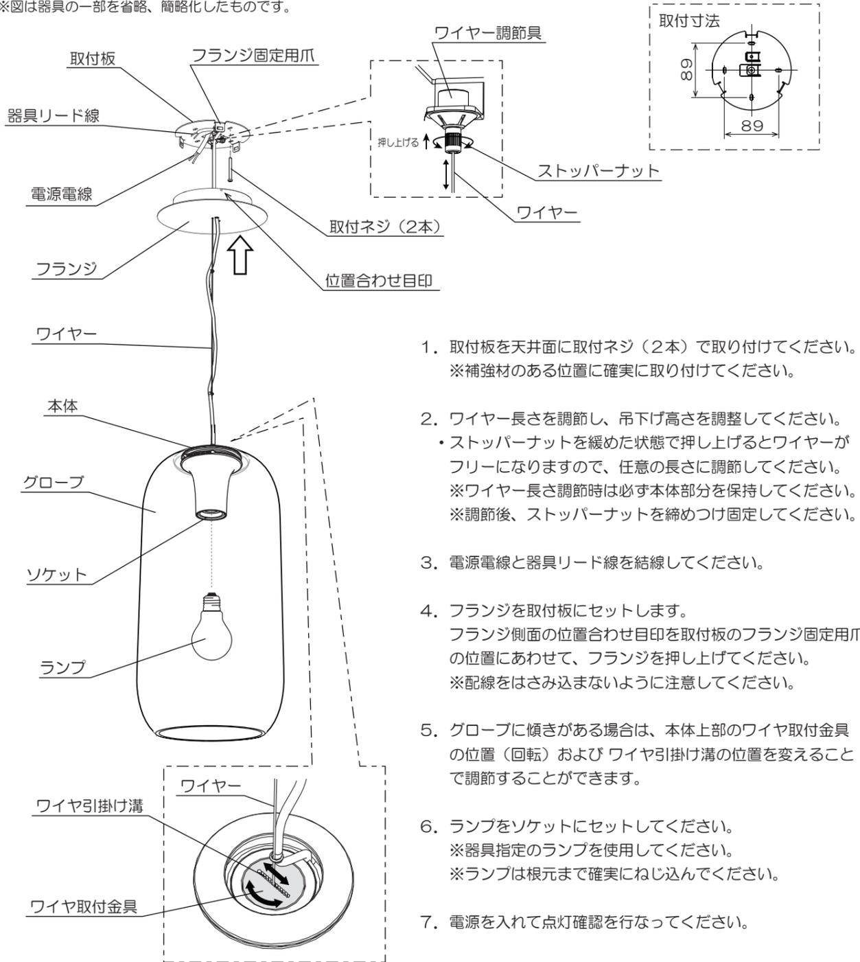
1. 取付板を天井面に取付ネジ（2本）で取り付けてください。
