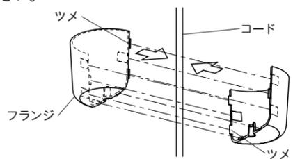
●コードハンガーを天井の補強材のある位置に取付けて、器具の高さを調節してください。
