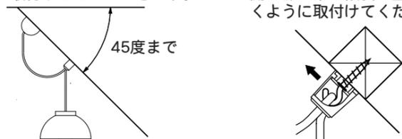
■傾斜天井への取付けは、必ず表記の制限傾斜角度・制限取付方向などをお守りください。器具の落下・破損の原因になります。
