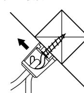
■傾斜天井への取付けは、必ず表記の制限傾斜角度・制限取付方向などを守りください。器具の落下・破損の原因になります。
