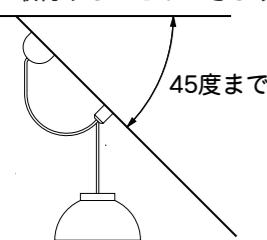
●取付け用のヒートンは、必ず補強材のある位置に設置して開口部が常に傾斜の上部を向くように取付けてください。
