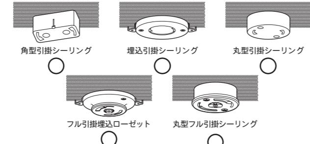
●上図以外の引掛けシーリングボディが付いている場合は、角型引掛けシーリングボディにお取り替えする工事を専門の電気工事店へご依頼してください。
