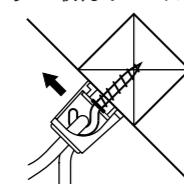
■ 傾斜天井への取付けは、必ず表記の制限傾斜角度・制限取付方向などを守りください。器具の落下・破損の原因になります。
