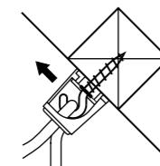
■ 傾斜天井への取付けは、必ず表記の制限傾斜角度・制限取付方向などを守りください。器具の落下・破損の原因になります。
