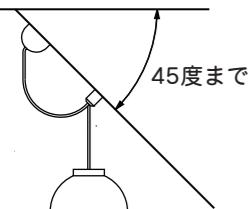
■傾斜天井への取付けは、必ず表記の制限傾斜角度・制限取付方向などをお守りください。器具の落下・破損の原因になります。
